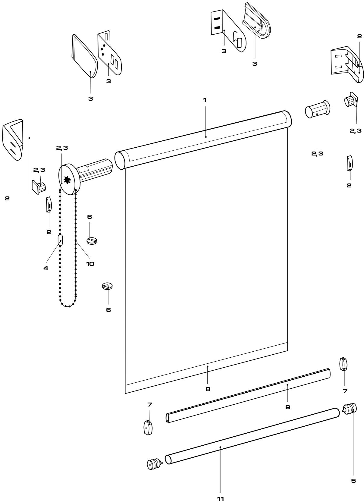
**комплектация для рулонных штор MGS-зебра**
